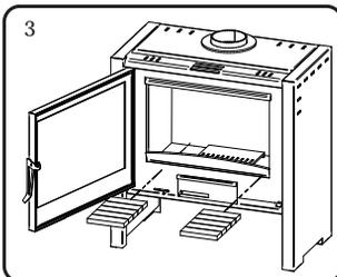
3. A continuación extraer el ángulo soporte lateral, ubicado en la parte inferior interna de su calefactor.
