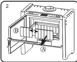
2. Retire el ángulo soporte posterior para seguir con los ladrillos, ubicados en el centro, continuando hacia los costados, deslizando y retirando los ladrillos individualmente.
