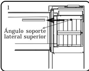
1. Retire el ángulo soporte lateral, ubicado en la parte superior de la caja de fuego, luego proseguir con los ladrillos laterales.
