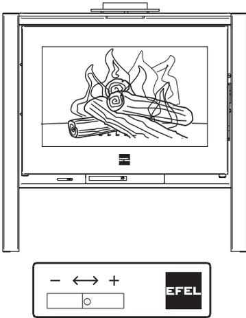
El control de aire primario esta dado por las manillas encontradas en la cara frontal inferior, para poner el control de aire primario en posición máxima, ud. debe moverlas completamente hacia la derecha de esta manera ud. estará incorporando oxígeno a la caja de fuego, para cerrarlo ambas deben ir hacia en sentido contrario (izquierda).
